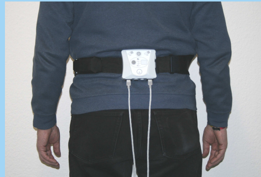
FastSCAN Funkeinheit Größe: 10 x 10 x 3 cm
